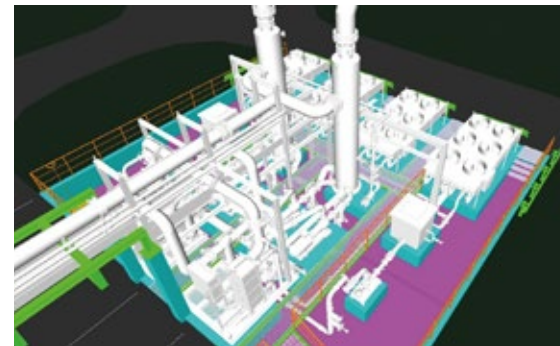
3D-Modell des Wiederaufbereitungssystems für das Kreislaufwasser
